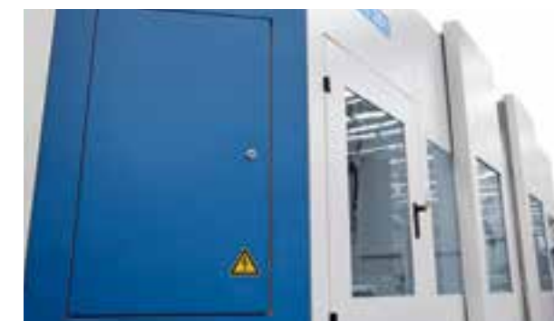
Vorn im Bild ist die Wartungsklappe zum Werkzeugwechsellerraum zu sehen, die Servicetüren für diesen Bereich haben Sichtfenster. Die Bedientüre zum Spanraum öffnet sich nach rechts und links automatisch.
