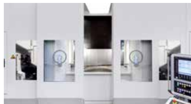
Die hüfthohe Trennwand vor dem Spanraum erlaubt die sichere Bedienung bei offener Tür.
